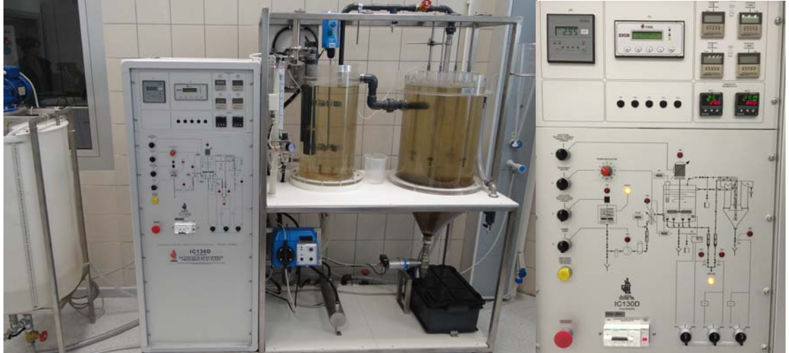
Рисунок №10. Лабораторная установка биохимической очистки сточных вод.
