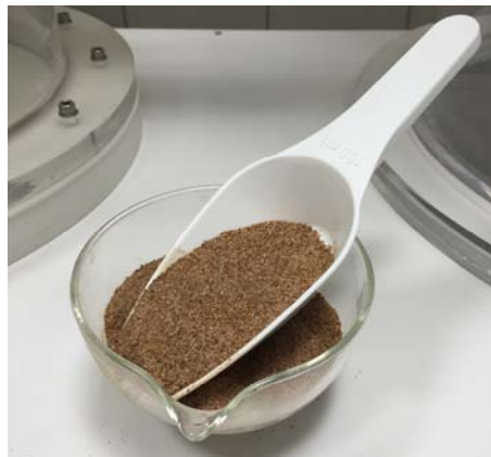
Рисунок №11. Биоценоз микроорганизмов для приготовления суспензии активного ила.
